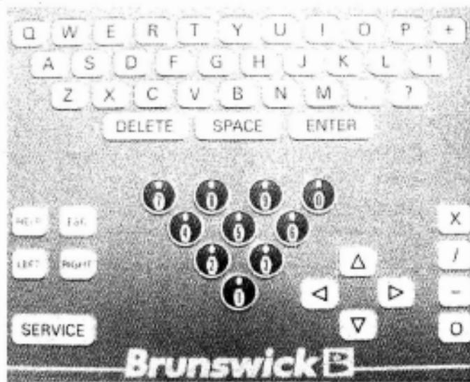
Le micro contrôleur scrute périodiquement les touches puis convertit la touche appuyée en code ASCII afin de le transmettre à l'électronique de la machine à requiller.
